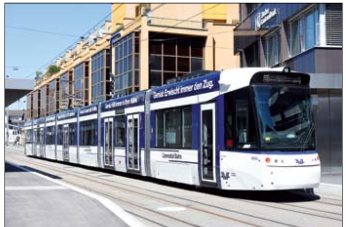
Tramway de la vallée de la Limmat (AVA): La motrice flamboyante neuve Be 6/8 8002 de type Tramlink effectue des courses d'essais à Dietikon le 10 août 2022. Photo extraite de Tram n° 152, page 80.
