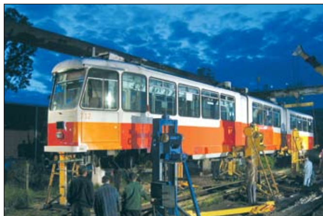
Iasi (RO): Au matin du 6 mai 2008, les motrices articulées arrivées de Berne ont été déchargées à Iasi en Roumanie au moyen de vérins hydrauliques. Voici la réception de la Be 8/8 712 (BVB 352). Le wagon de transport a été retiré et la motrice est sur le point d'être posée sur la voie métrique. Photo extraite de Tram n° 95, page 28. Prise de vue: Radu Czech / Cristina Albu
